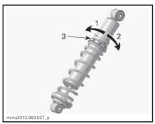
CAM TYPE - HPG SHOCK ABSORBER
