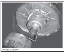
PULLEY EXPANDER ON ADJUSTER HUB
