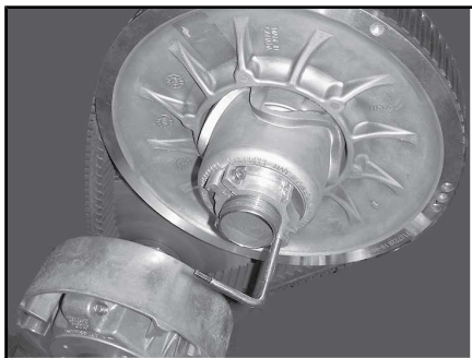
TYPBILD - VARIATORUTVIDGARE INSTALLERAD PÅ JUSTERINGSNAVET
