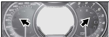
BILDET VISER – KONTROLLAMPER
