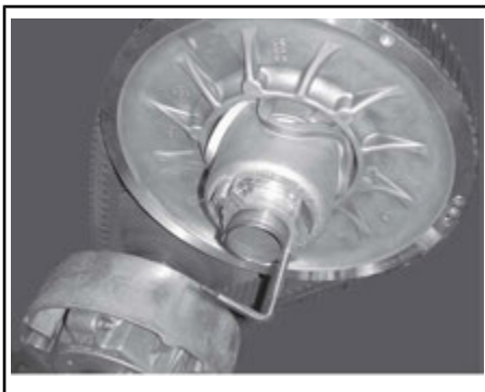
VARIATORNS UTVIDGARE INSTALLERAD PÅ JUSTERINGSNAV I ALUMINIUM
