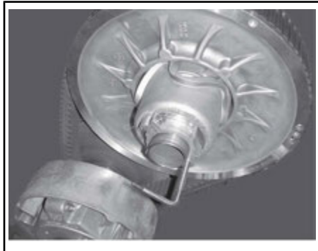
SCHEIBEN-EXPANDER AN NABE DER ALUMINIUM-EINSTELLVORRICHTUNG
