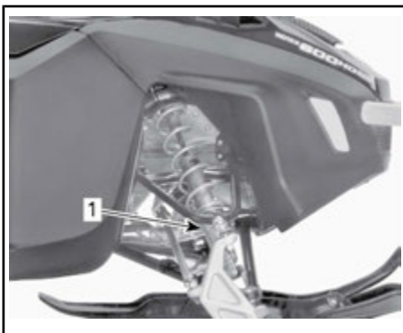
TYPISCH - VORSPANNUNGSEINSTELLUNG DURCH NOCKE
