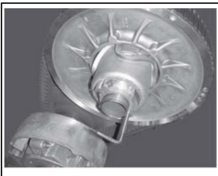
DISPOSITIVO DI ESPANSIONE DELLA PULEGGIA SUL MOZZO DEL REGISTRO IN ALLUMINIO.
