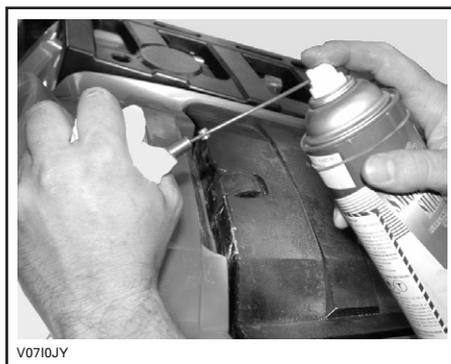
**NOTA:** Ponha um trapo à volta do regulador do cabo do acelerador para evitar que o lubrificante espirre.
