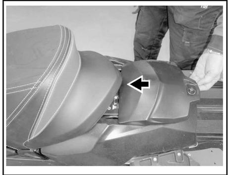
Einbau durch Verriegeln der Aufbewahrungs-/Batteriefachabdeckung abschließen.
