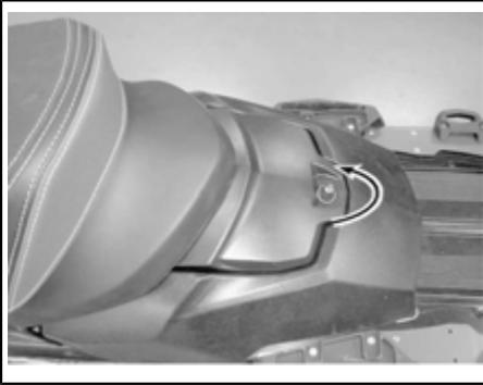
Den Sitz durch gleichzeitiges Ziehen und Anheben entfernen.
