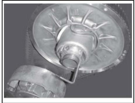
*SCHEIBEN-EXPANDER AN NABE DER EINSTELLVORRICHTUNG MONTIERT*
