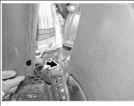
Zum Entfernen einer Seitenverkleidung öffnen Sie diese und heben sie an. Lösen Sie das untere Gelenk aus seiner Aussparung und lösen Sie anschließend das obere Gelenk durch Absenken der Verkleidung.
