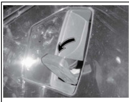
TREKK FOR Å KOBLE INN REVERSGIR
