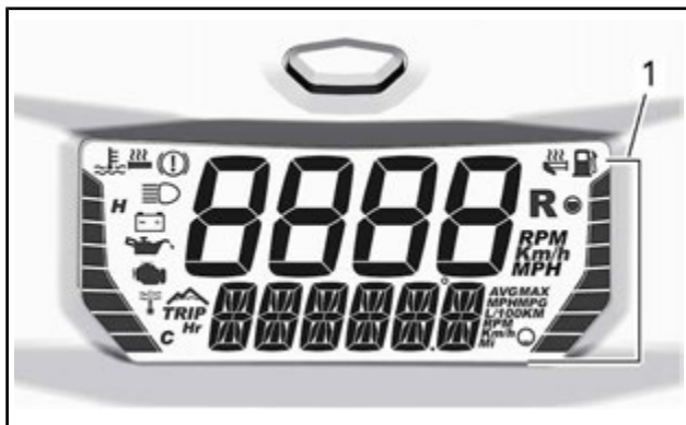
1. Søylemåler høyre side
