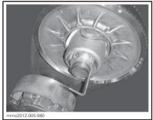
PULLEY EXPANDER ON ALUMINUM ADJUSTER HUB
