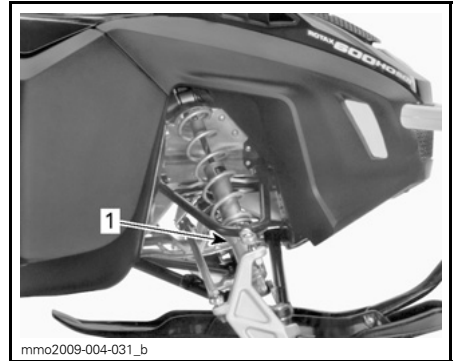
TIPICO - PRECARICO CAMMA 1. Camma di regolazione
