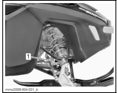
TYPBILD - FÖRSPÄNNING AV KAMTYP 1. Justeringskam
