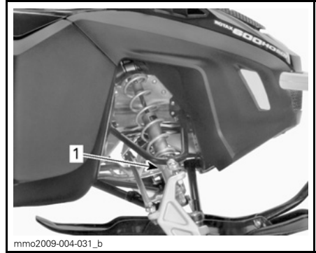
TYYPILLINEN - SÄÄTÖNOKKATYYPPIINEN ESIJÄNNITYS 1. Säätönokka
