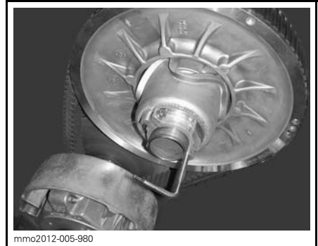
SCHLEIBEN-EXPANDER AN NABE DER EINSTELLVORRICHTUNG MONTIERT
