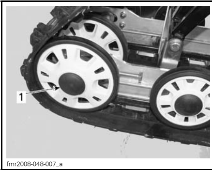
1. Kappe des rechten hinteren Zwischenrads
