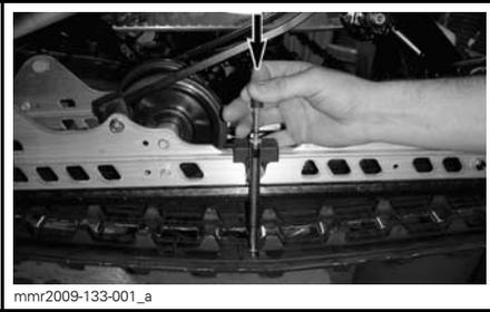
11. Se la lettura del carico non corrisponde alla specifica, regolare la tensione del cingolo. Vedere la parte intitolata *REGOLAZIONE DELLA TENSIONE DEL CINGOLO*.
