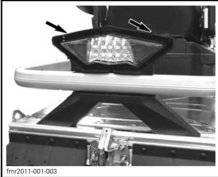
**AVVISO** Esercitando una forza laterale eccessiva sul gruppo fanalino posteriore, si rischia di spezzare i fermi perno in plastica. Nell'estrarre il gruppo fanalino posteriore, evitare di esercitare movimenti laterali.
