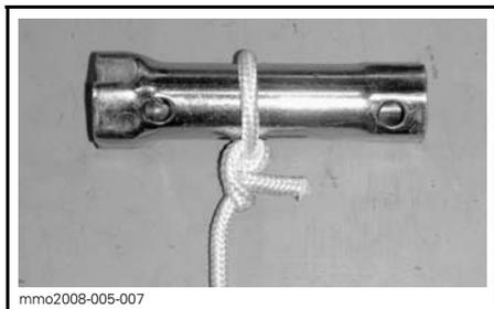
3. Collegare l'altra estremità della fune di emergenza al fermaglio di avviamento fornito con il kit strumenti.
