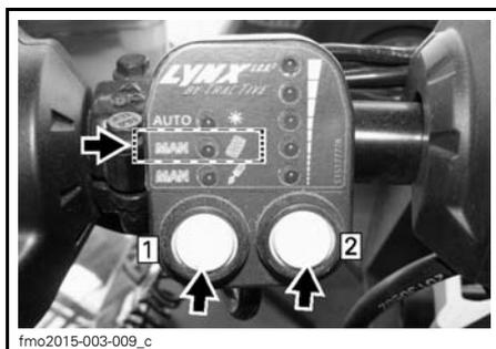
Per modificare il precarico della molla, premere il pulsante a sinistra finché non si accende il LED MAN/molla. Premere la manopola destra per impostare il precarico. Più LED si illuminano, maggiore sarà il precarico impostato.
