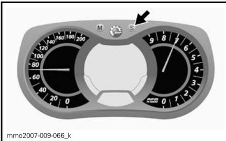
Per modificare le ore, quando il valore HOURS lampeggia, utilizzare il pulsante SET (S) per cambiare le ore.
