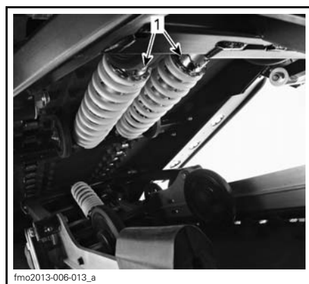
DUBBEL BAKRE STÖTDÄMPARE 1. Justering av bakfjädringen
