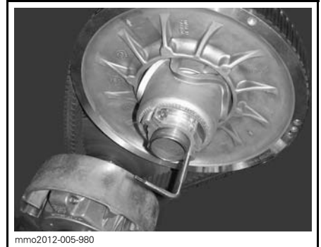
mmo2012-005-980 FORLENGER FOR DRIVREIMSKIVE MONTERT PÅ JUSTERINGSNAV
