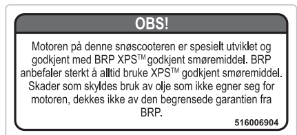
DEKAL 3 – I MOTORROMMET
