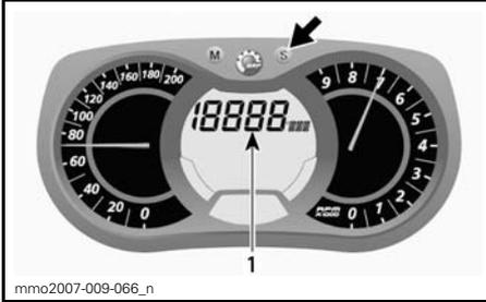
1. Modus Fahrzeugdurchschnittsgeschwindigkeit (AVR\_SPD)
