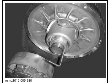
mmo2012-005-980 VARIATORNS UTVIDGARE INSTALLERAD PÅ JUSTERINGSNAV I ALUMINIUM
