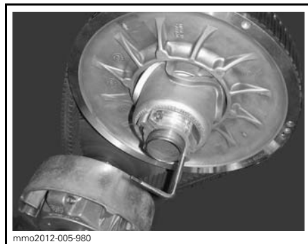
mmo2012-005-980 VARIATORNS UTVIDGARE INSTALLERAD PÅ JUSTERINGSNAVET
