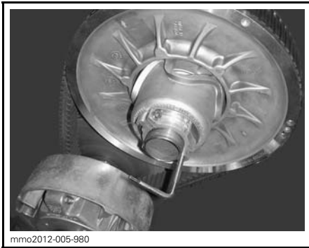
mmo2012-005-980 ÉCARTEUR DE COURROIE INSTALLÉ SUR LE MOYEU DE RÉGLAGE
