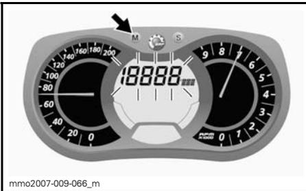
Drücken Sie die Taste SET (S), während die Anzeige blinkt, um den Modus Fahrzeugdurchschnittsgeschwindigkeit (AVR\_SPD) auszuwählen.
