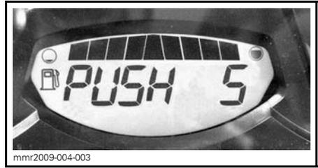
5. Lassen Sie alle Tasten los, wenn das Anzeigeelement **DRÜCKEN SIE "S"** anzeigt.
