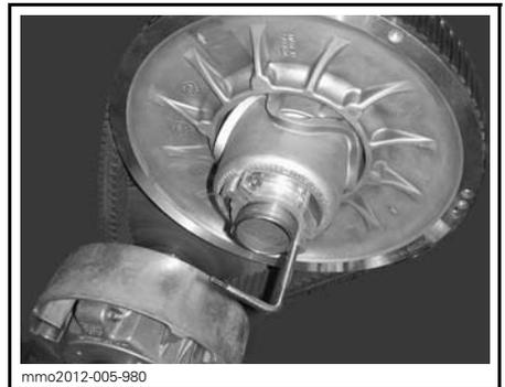
*SCHEIBEN-EXPANDER AN NABE DER EINSTELLVORRICHTUNG MONTIERT*
