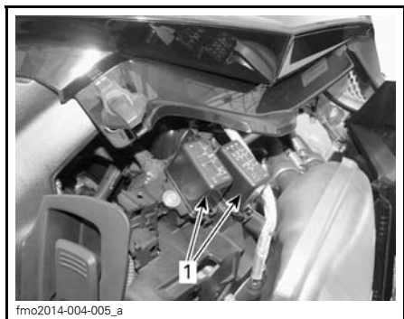
1. Boîtes à fusibles
