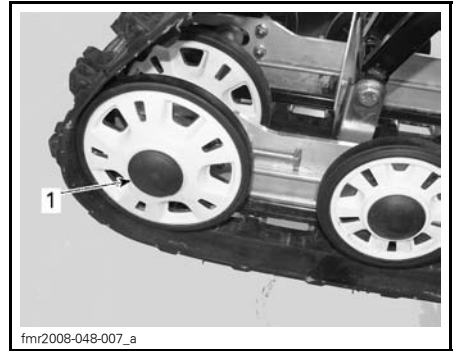
fmr2008-048-007_a 1. Kappe des rechten hinteren Zwischenrads
