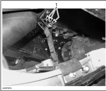
TYPISCH 1. Einstellungsbohrungen (Stopperriemen)
