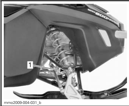
TYPBILD - FÖRSPÄNNING AV KAMTYP 1. Justeringskam
