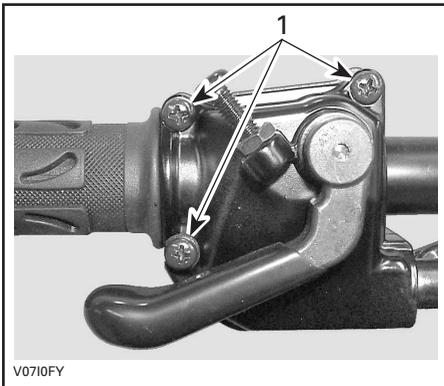
1. Diese Schrauben entfernen
