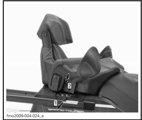
Schritt 1: Gummilasche ziehen Schritt 2: Rechte Seite anheben
