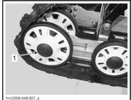
1. Kappe des rechten hinteren Zwischenrads
