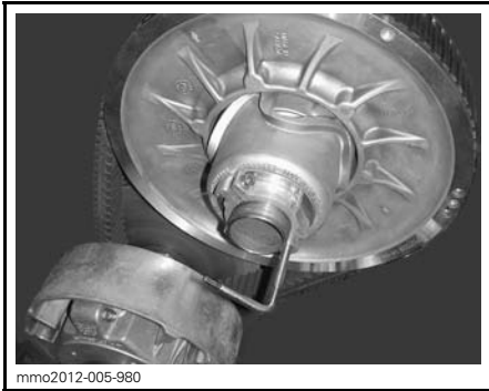
SCHEIBEN-EXPANDER AN NABE DER ALUMINIUM-EINSTELLVORRICHTUNG
