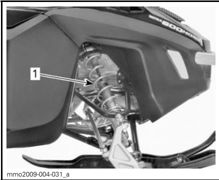
TYPISCH - VORDERE AUFHÄNGUNG 1. Vordere Federn für Fahrverhalten
