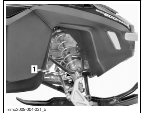
TYPISCH - VORSPANNUNGSEINSTELLUNG DURCH NOCKE 1. Einstellnocken
