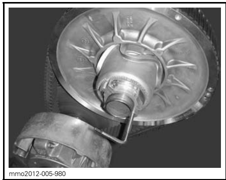
mmo2012-005-980 ÉCARTEUR DE COURROIE INSTALLÉ SUR LE MOYEU DE RÉGLAGE
