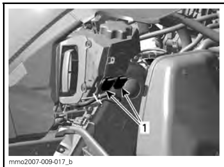
HØYRE SIDE AV MOTORROMMET 1. Plassering av sikring
