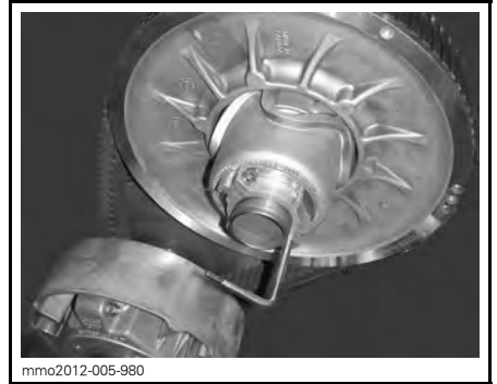
VARIAATTORIN AVAUSTYÖKALU ASENNETTUNA SÄÄTIMEN NAPAAN
