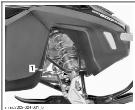
TIPICO - PRECARICO CAMMA 1. Camma di regolazione
