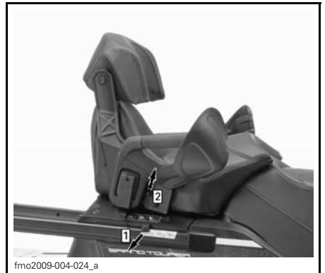
Étape 1: Tirez sur le loquet en caoutchouc Étape 2: Soulevez le côté droit
