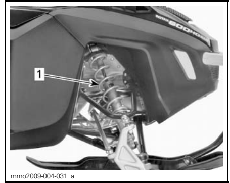
TYPIQUE - SUSPENSION AVANT 1. Ressorts avant pour la maniabilité
