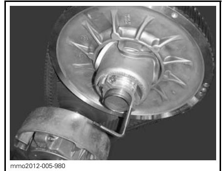
VARIATORNS UTVIDGARE INSTALLERAD PÅ JUSTERINGSNAV I ALUMINIUM
