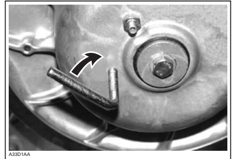
VERKTØY FOR Å MONTERE / TA AV DRIVREIMEN
