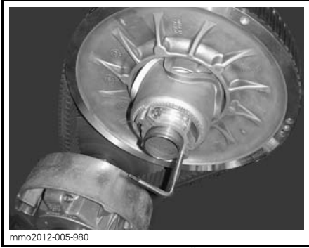
VARIAATTORIN AVAUSTYÖKALU ASENETTUNA SÄÄTIMEN NAPAAN
