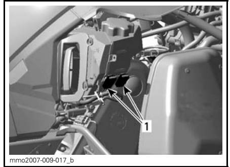
mno2007-009-017_b HÖGER SIDA AV MOTORUTRYMMET 1. Säkringarnas placering
