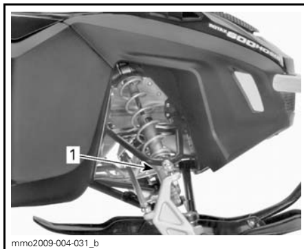
TIPICO - PRECARICO CAMMA 1. Camma di regolazione
