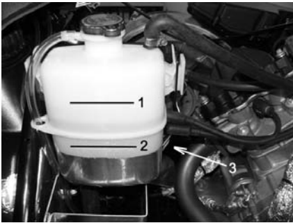
YETI PRO V-800-EXPANSIONSTANK NÄRA LJUDDÄMPAREN
