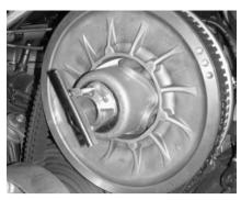
EXPANDER INSTALLED ON SCREW TYPE DRIVEN PULLEY
