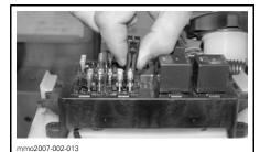
TYPICAL — REMOVE FUSE USING TOOL
