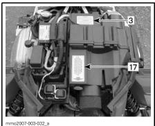
AIR INTAKE SILENCER (ENGINE SIDE) --LIQUID-COOLED
