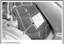
AIR INTAKE SILENCER (ENGINE SIDE) — FAN-COOLED
