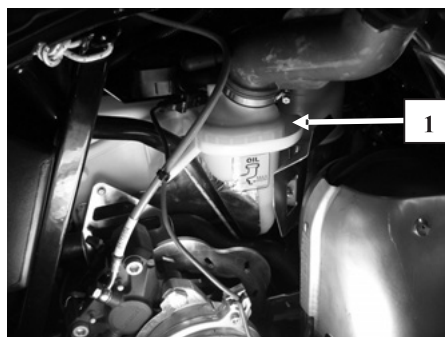
1. Maximal oljenivå (fyll inte på för mycket)
