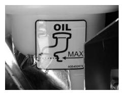
SEE MAX OIL LEVEL DECAL ON THE SIDE OF THE OIL TANK
