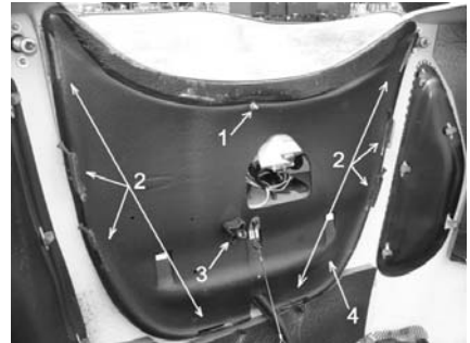
1. Lossa den elastiska fläsmuttern M5 2. Avlägsna spärrarna till vindrutan 3. Lossa ratten för strålkastarjustering 4. Ta bort mellanlagret
