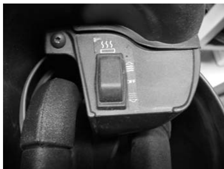
REGLAGE FÖR PASSAGERARENS HANDTAGSVÄRMARE PÅ PASSAGERARHANDTAGET
