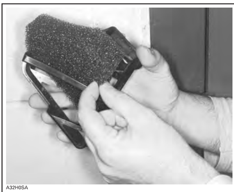
Depose du filtre de sa grille
