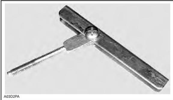
EINBAUWERKZEUG/AUSBAUWERKZEUG FÜR DEN KEILRIEMEN
