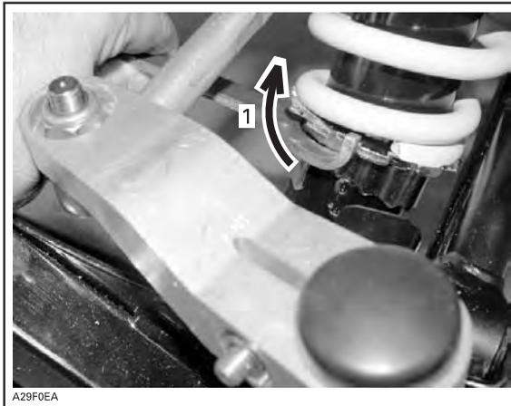
1. Federvorspannung erhöhen
