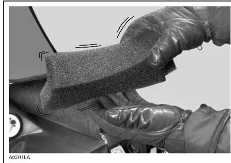
Entfernen Sie Schnee vom Filter des Einlaß-Schalldämpfers.
