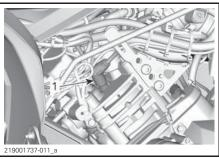
RH SIDE — REAR CYLINDER 1. Spark plug
